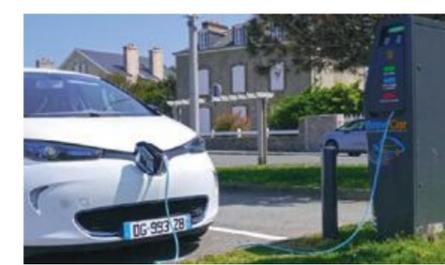
Une borne de recharge accélérée, accessible 7 j/7, 24/24, permet une recharge partielle (environ 20 km d'autonomie en 15 minutes). Elle possède deux points de charge.
